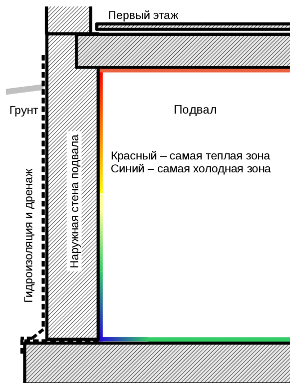
Распределение температуры стены подвала
